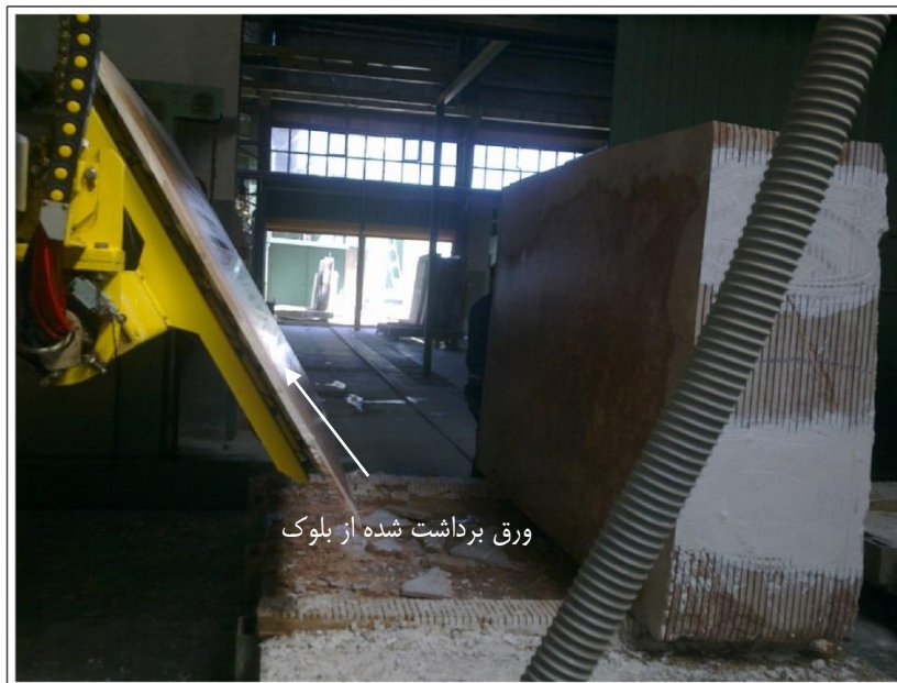
شکل ۲-۱۴- جدا کردن ورق‌های بریده شده با دستگاه مکش
