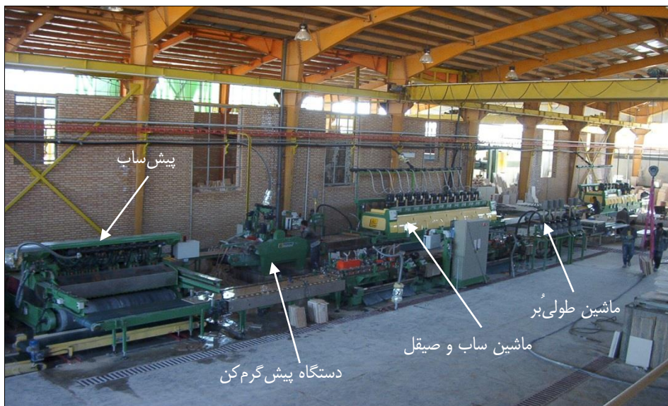
شکل ۳-۴- چیدمان خطی ماشین‌آلات در کارخانه فرآوری سنگ‌های تزئینی و نما
