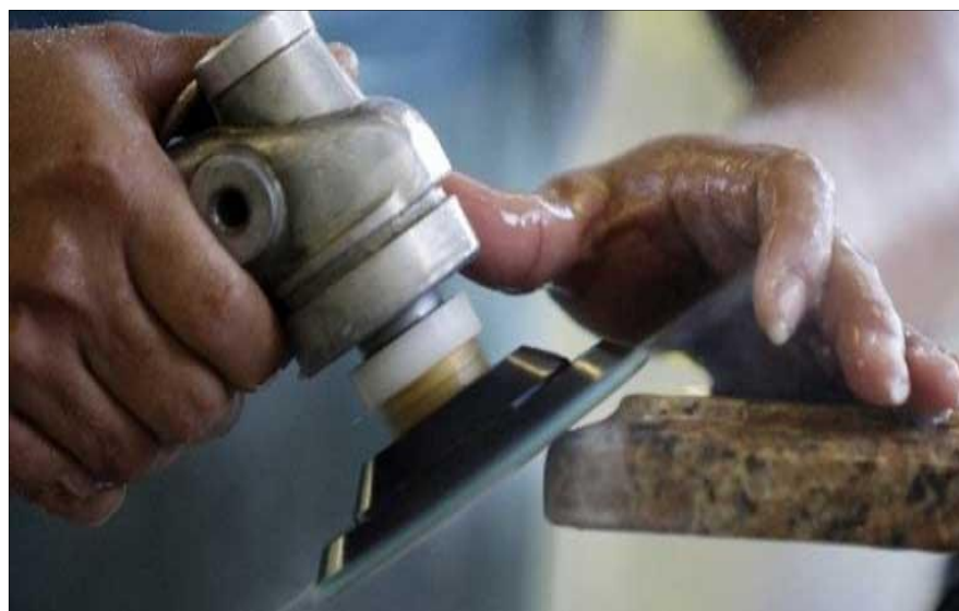
شکل ۲-۱۳- لبه‌زنی دستی گرانیت با دیسک
