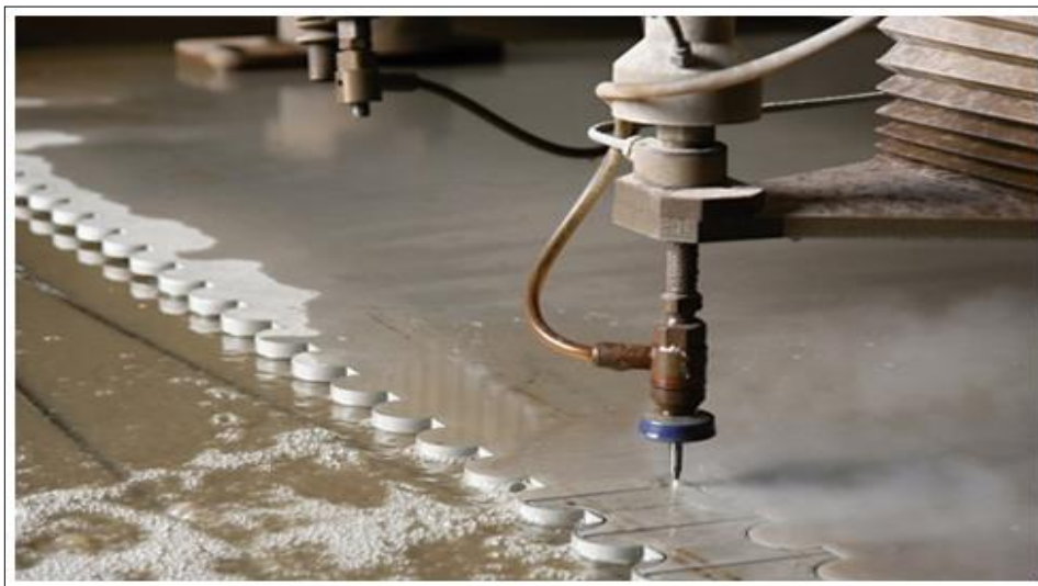
شکل ۴-۱۱- خروج آب از نازل و نحوه برش به وسیله ماشین برش با آب
