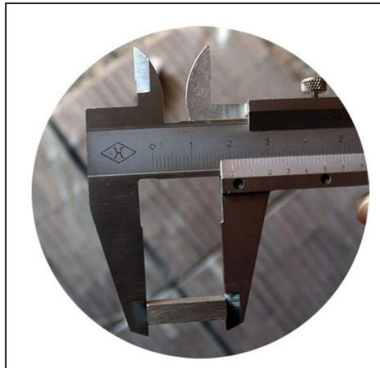
شکل ۲-۱۹- نمایش اندازه‌گیری سگمنت
